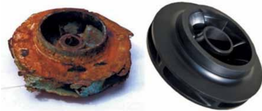
4.1 Сурет – Кавитация салдарынан жұмыс дөңгелектерінің бұзылуы
